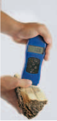
Messung des Wassergehaltes mit einem Schnellbestimmungsgerät
